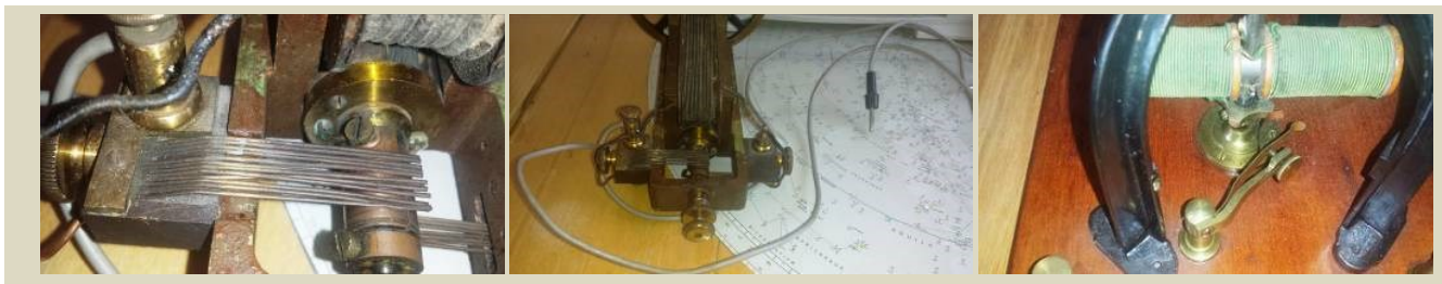
Zľava elektromotor na jednosmerný prúd (po roku 1900), vpravo elektromotor na striedavý prúd (prelom 19. a 20. stor.)
